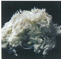
白石綿 (クリソタイル)
