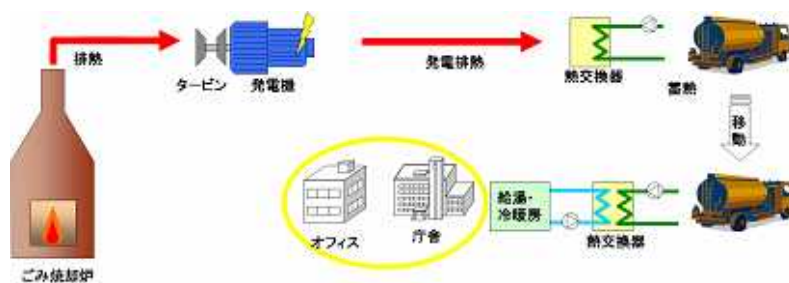
図4-8 排熱利用の概念図
