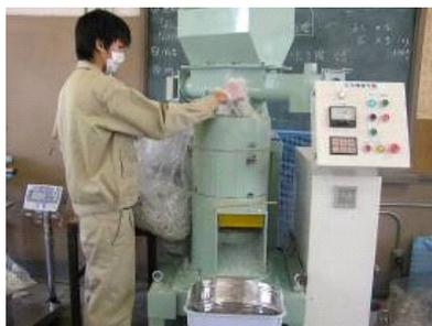
図1-9 岡山県立津山工業高等学校のペレット製造設備
