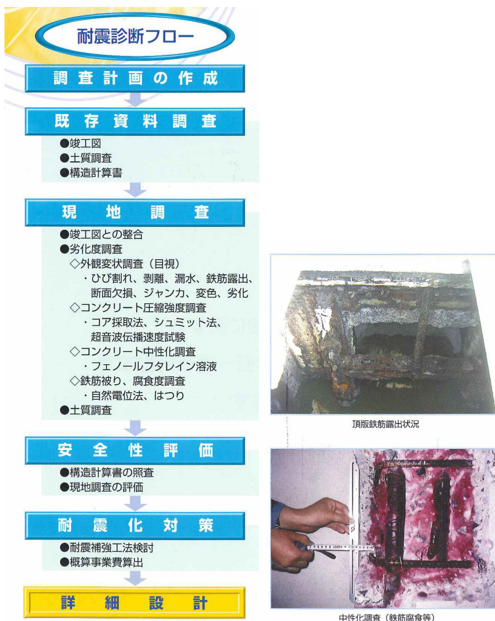
中性化調査（鉄筋腐食等）
