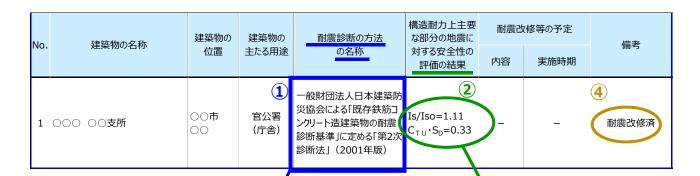
附表 耐震診断の評価の結果と構造耐力上主要な部分の地震に対する安全性の評価
