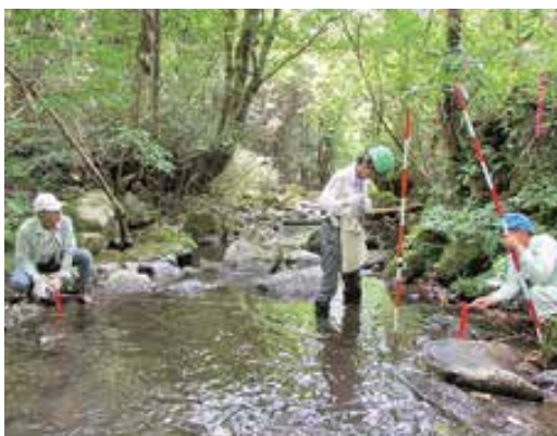
落合川流域の流量調査の様子
