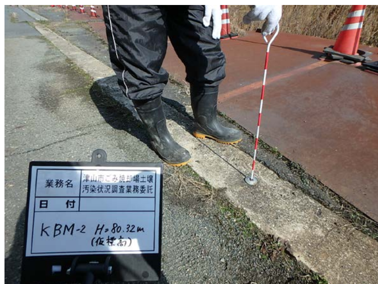
写真 4-2-1-4. 仮ベンチマーク KBM-2 近景
