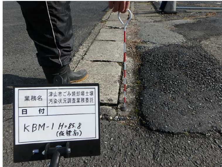
写真 4-2-1-2. 仮ベンチマーク KBM-1 近景
