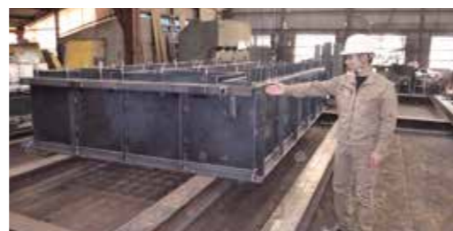
集塵機の一部。津山圏域クリーンセンター（領家）でも採用されている
