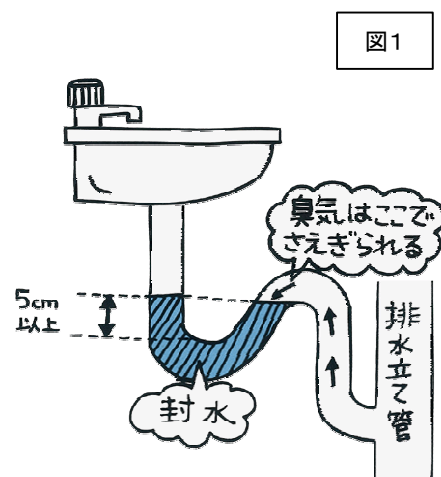
排水トラップのしくみ
